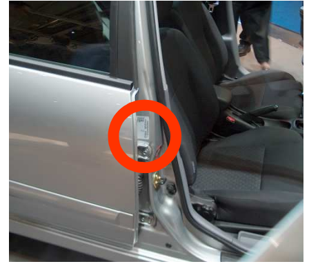
VIN PLATE POSITION ALMERA
